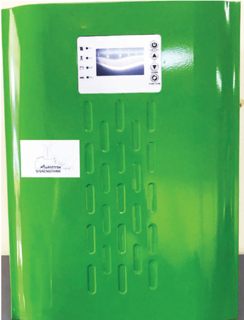
อินเวอร์เตอร์ออฟกริด 1,800 วัตต์ MPPT ในตัว
